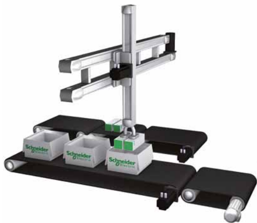
Сервопривод LXM 32: управление упаковочным станком
